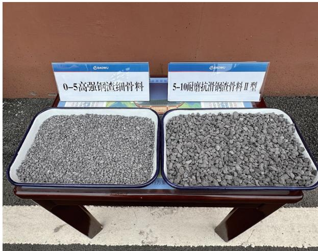
的消耗。不仅如此，在材料性能方面，钢渣对比玄武岩更表现出优异性能，抗压强度、耐磨等提升了 15% 以上。
