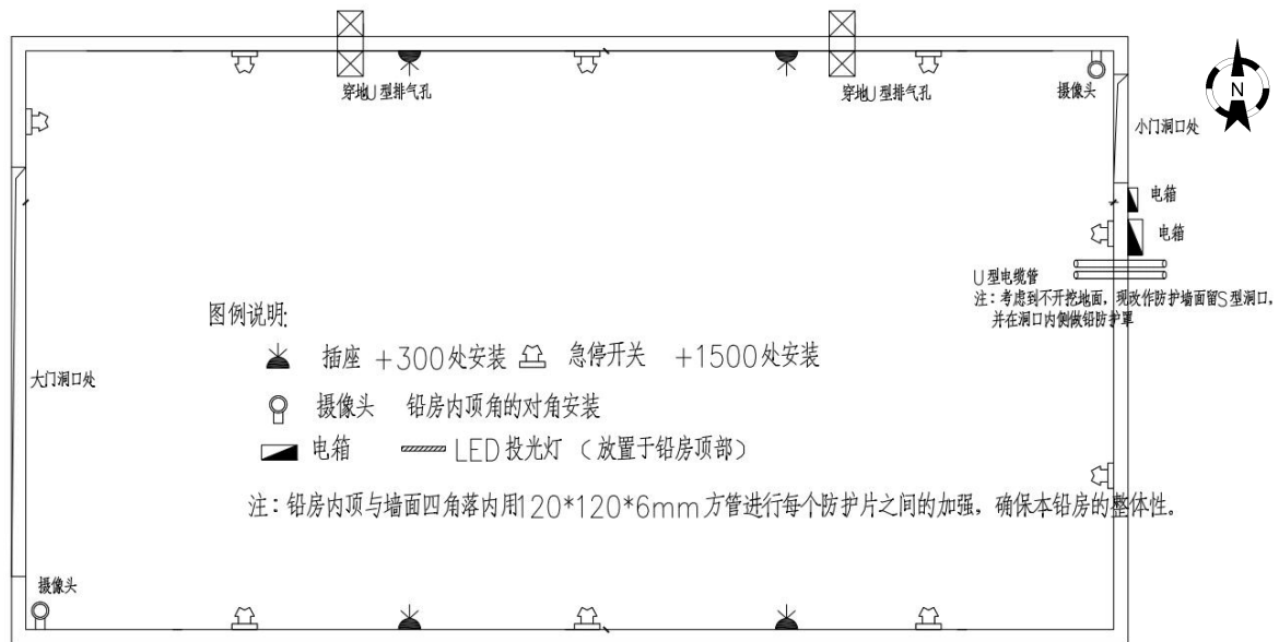
图 10-1 探伤铅房内部布置示意图
