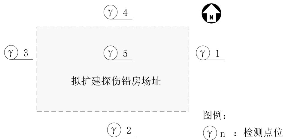
图 8-2 拟建址周围环境 X、γ辐射监测点位示意图
