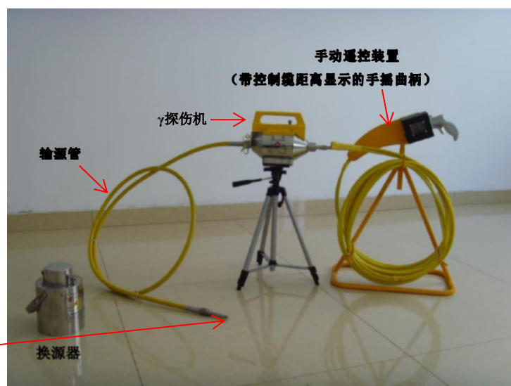
图 9-1 \gamma 射线探伤机结构示意图
