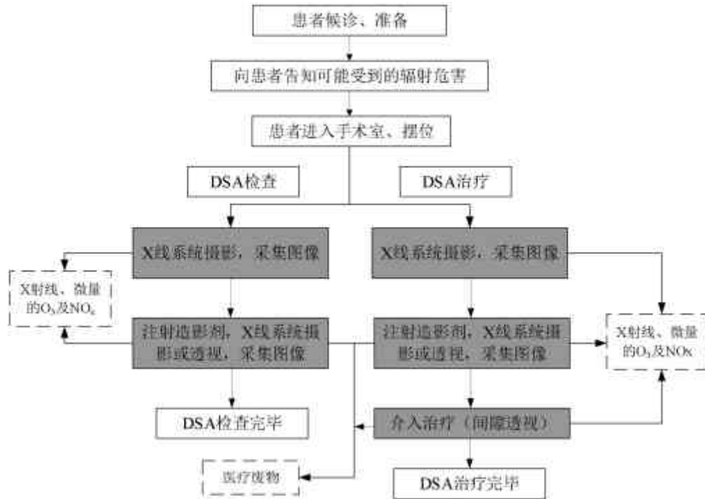
图 9-4 扩建 DSA 介入诊疗项目工作流程及产污环节示意图
