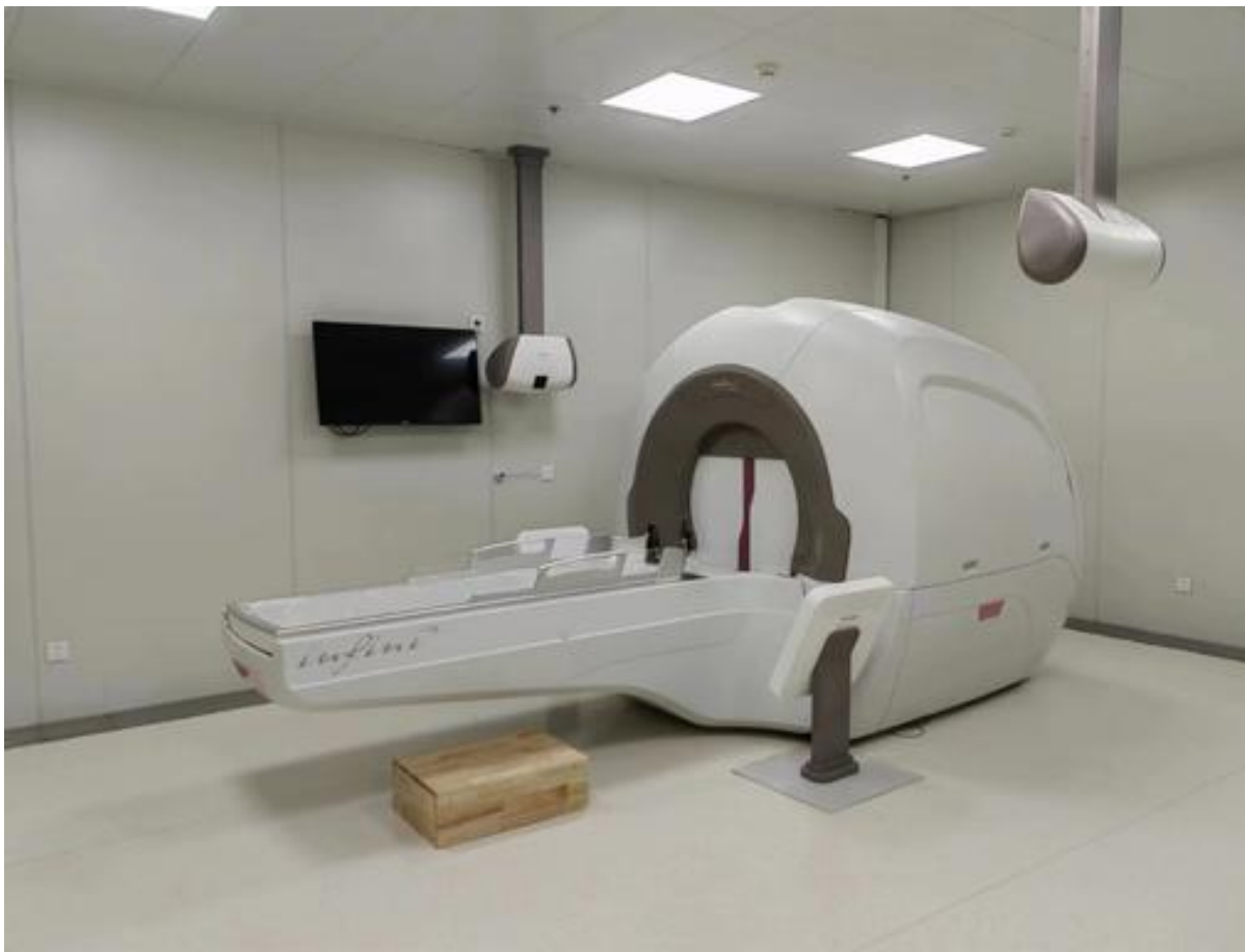
图 9-1 本项目 SRRS+型头部多源 \gamma 射束立体定向放射治疗系统外观图
