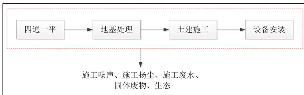
图4-1 施工期工艺流程及产污环节图
