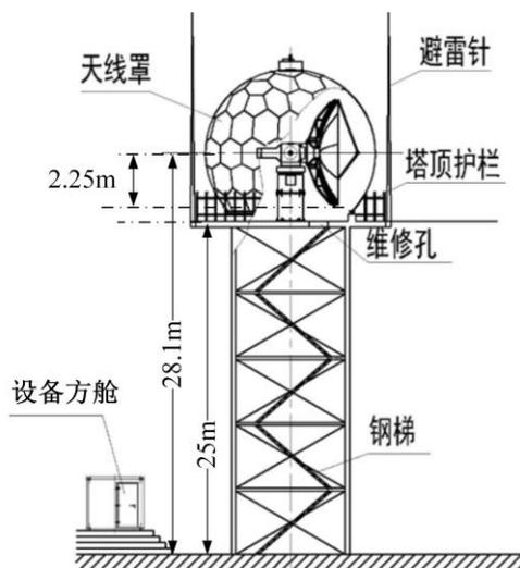
图4-3 雷达系统设备布局示意图
