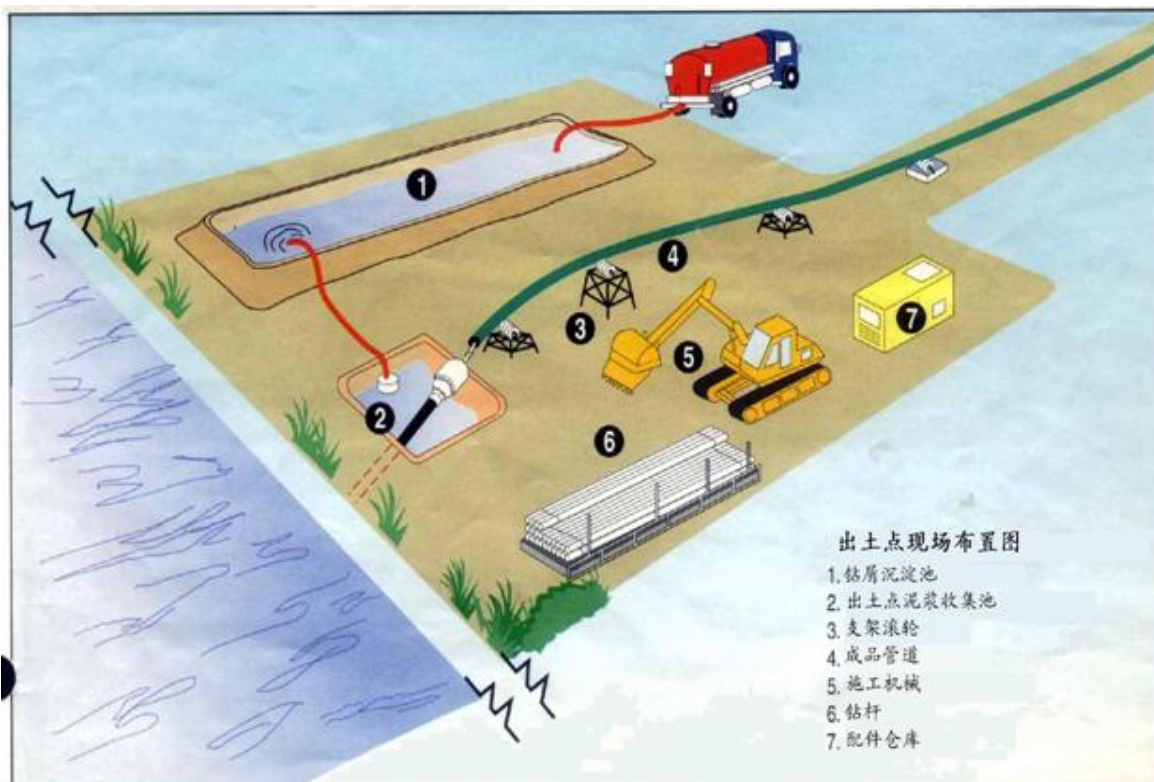
图 4.2-15 定向钻穿越工程出土场地示意图
