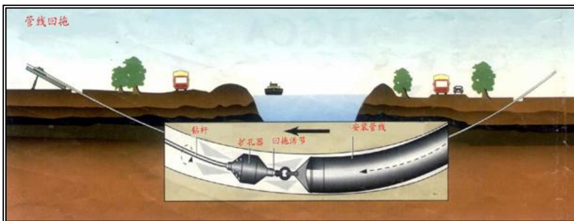
图 4.2-13 管线回拖示意图
