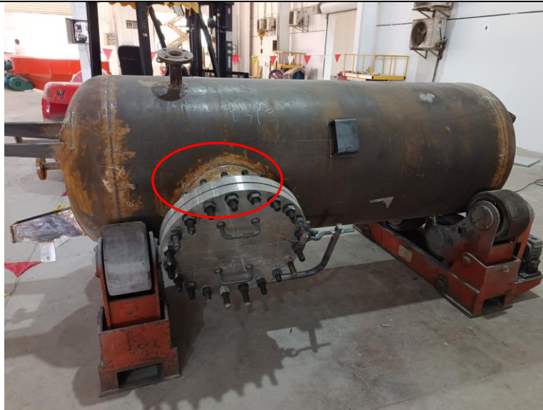
图 9-7 本项目主要探伤工件部位示意图
