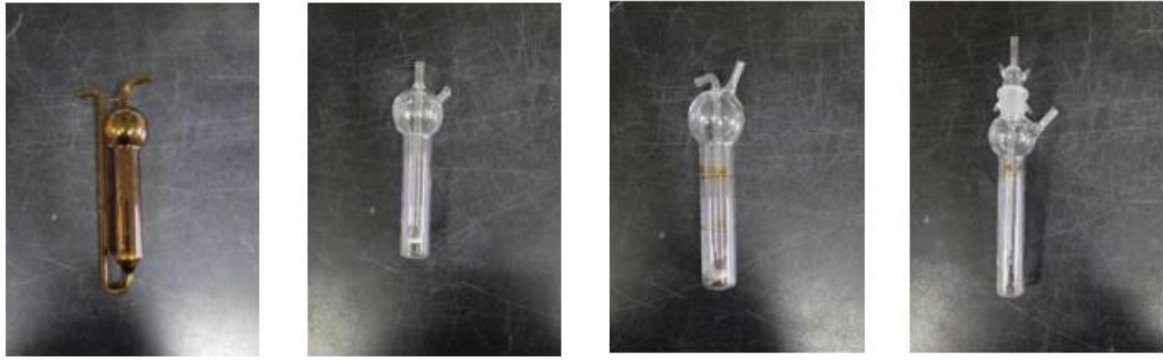
第 1 种：50ml 棕色 U 型多孔玻璃吸收瓶 第 2 种：25ml 直型多孔玻璃吸收瓶 第 3 种：50ml 直型多孔玻璃吸收瓶 第 4 种：25ml 冲击式吸收瓶
