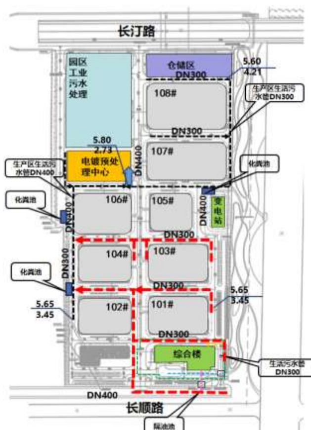
图 7.2.1-1 废水收集管廊走向图
