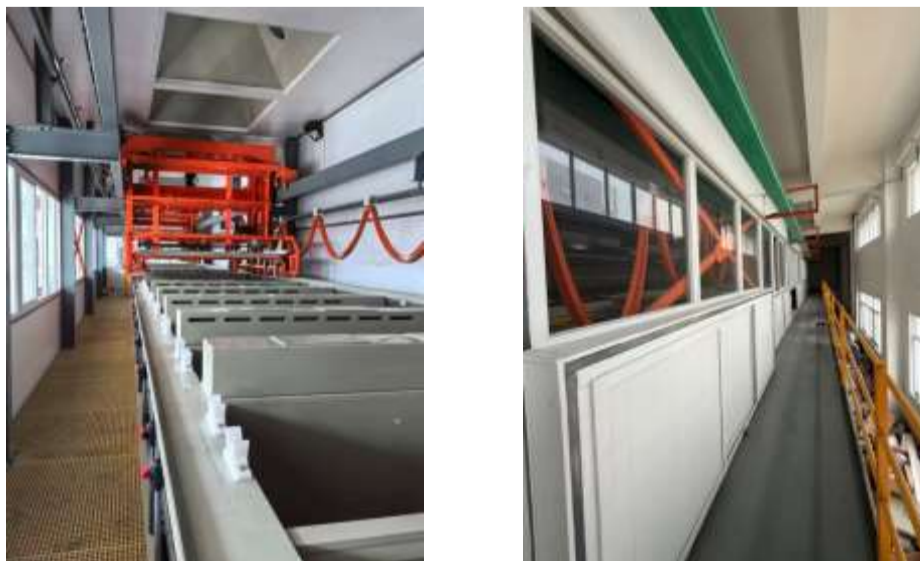
图 7.3.2-2 顶吸+产线塑钢密闭示意图
