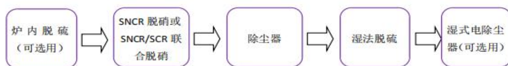
图 8.1-2 超低排放工艺流程 2（循环流化床锅炉）
