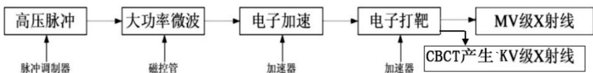
图 9-3 本项目医用直线加速器原理图
