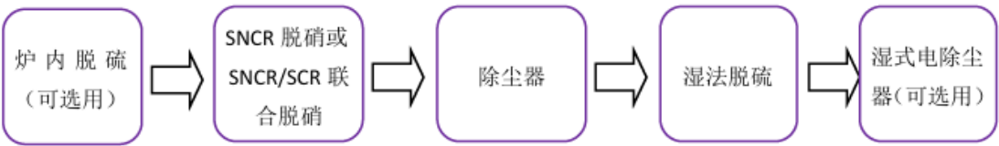
图 7.2-2 循环流化床锅炉的超低排放工艺流程图 1
