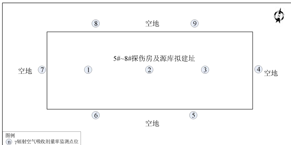
图 8-2 5#~8#探伤房及源库拟建址周围环境 \gamma 辐射空气吸收剂量率检测点位示意图
