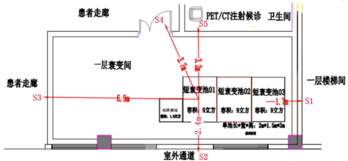
图 11-4 衰变池周边剂量率预测示意图
