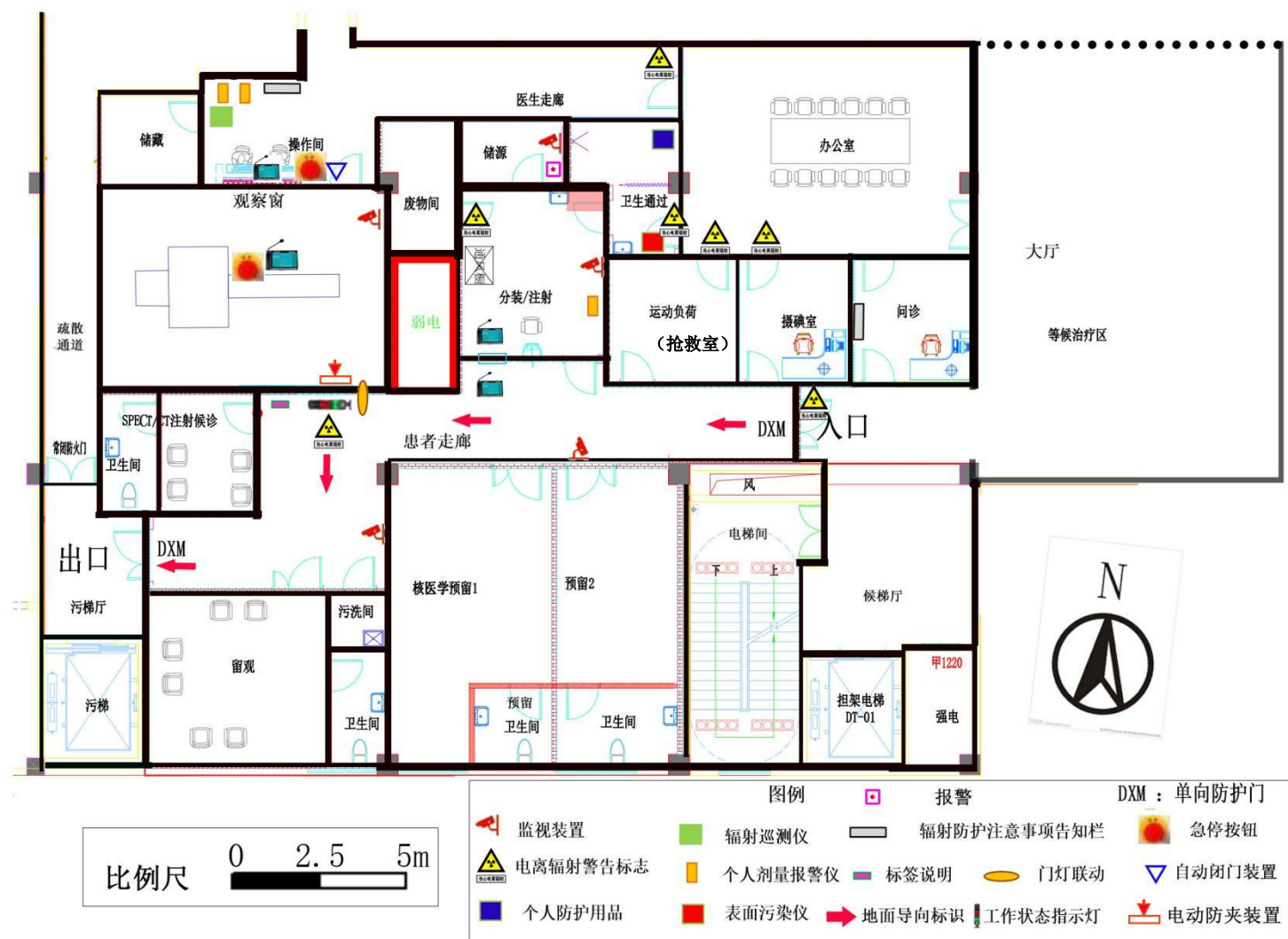
图 10-6 本项目核医学二层 SPECT/CT（包括使用 I-131 诊疗）工作场所辐射安全与防护设施分布示意图
