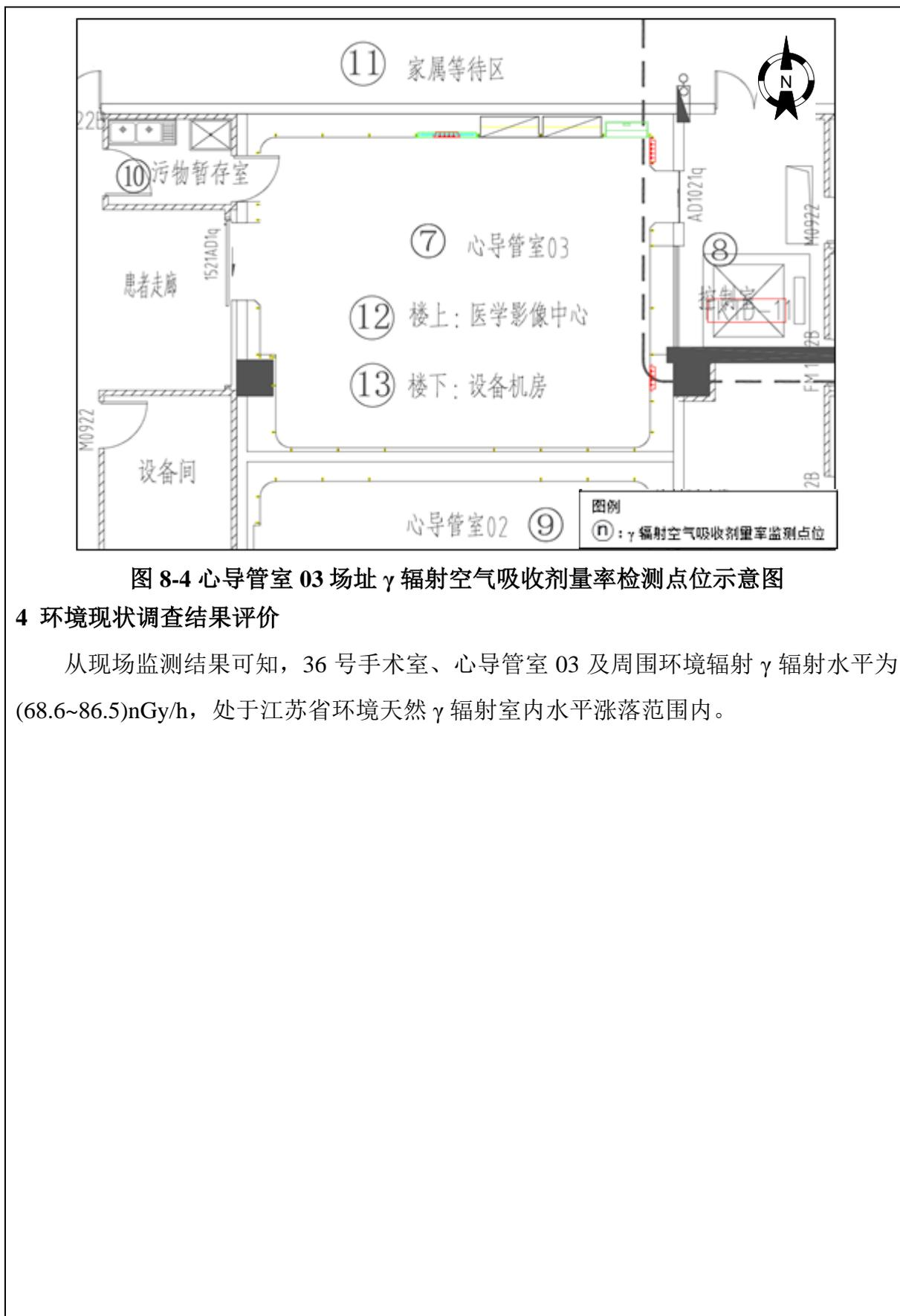
图 8-4 心导管室 03 场址  $\gamma$  辐射空气吸收剂量率检测点位示意图
