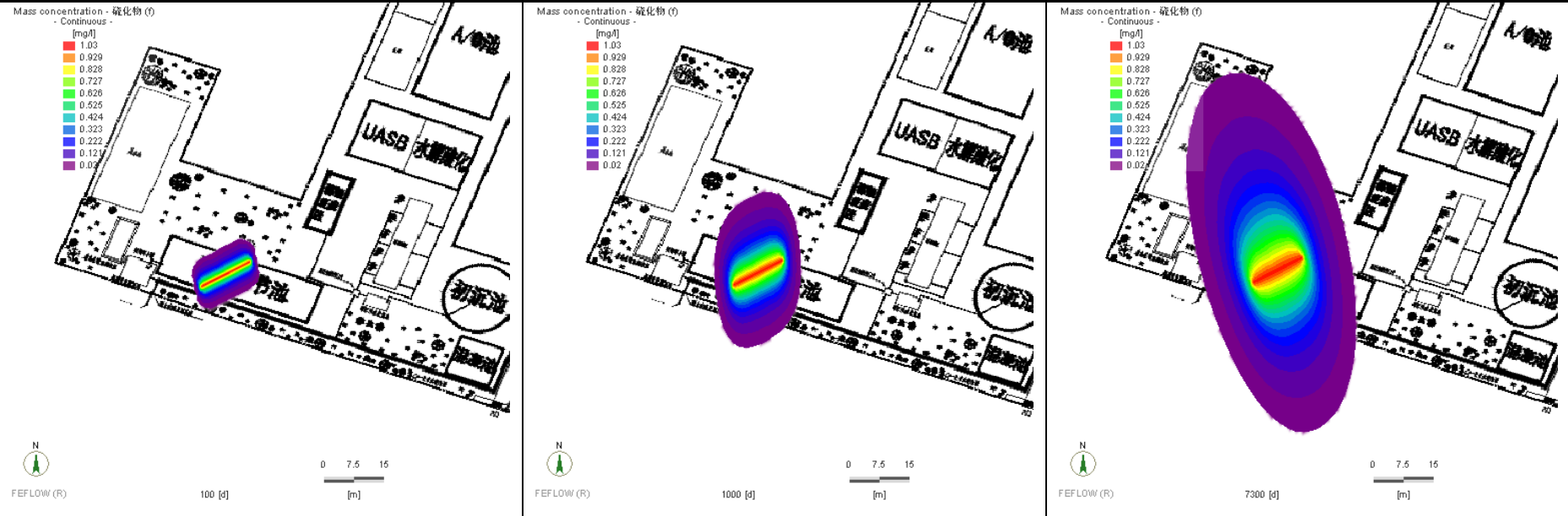
图 6.2.3-10 非正常状况下，污水站调节池底破损污染物渗漏污染物浓度分布图（硫化物）
