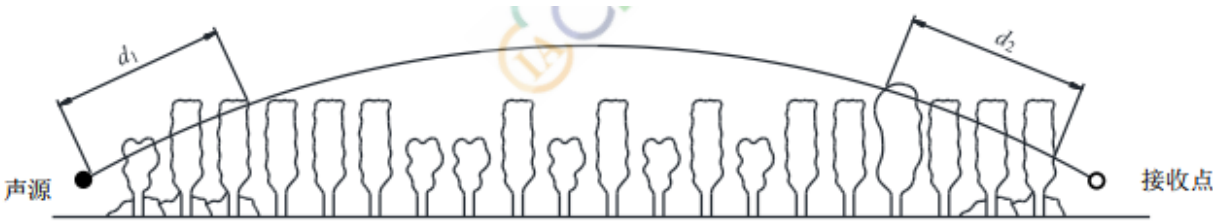
图 6.2.4-2 通过树和灌木时噪声衰减示意图
