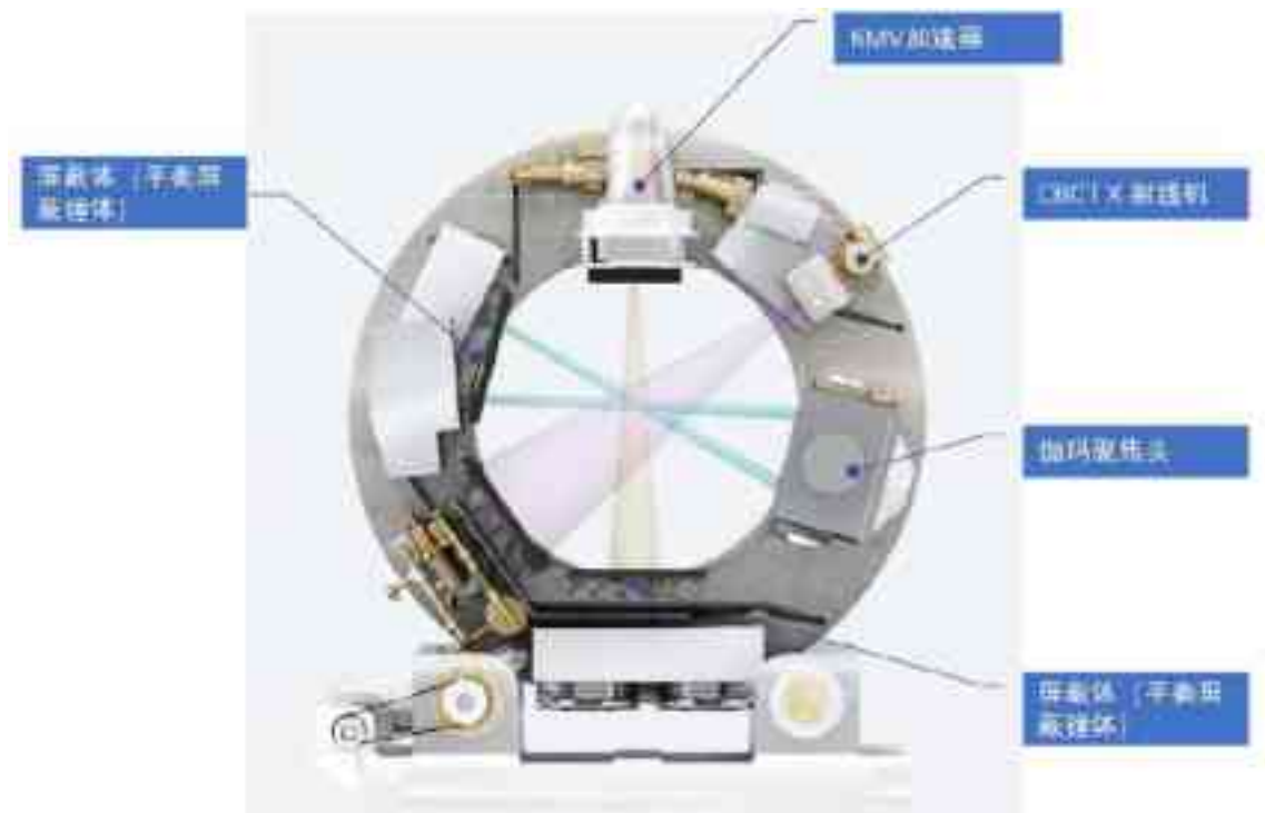
图 9-4 Taichi Pro 型多模式一体化放射治疗系统主机系统结构示意图
