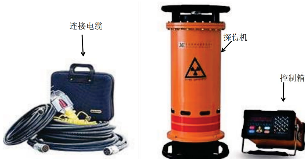
图 9-1 本项目 X 射线探伤机、控制箱及连接电缆
