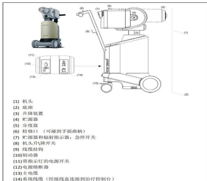
图 9-5 典型后装机结构示意图
