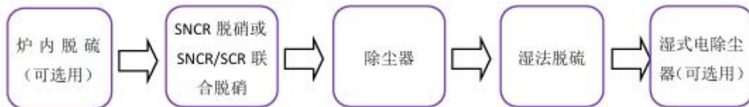
图 7.2.2-1 (1) 超低排放工艺流程 2 (循环流化床锅炉) (HJ 2053-2018)
