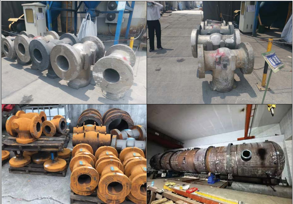
图 9-13 本项目主要探伤工件示意图
