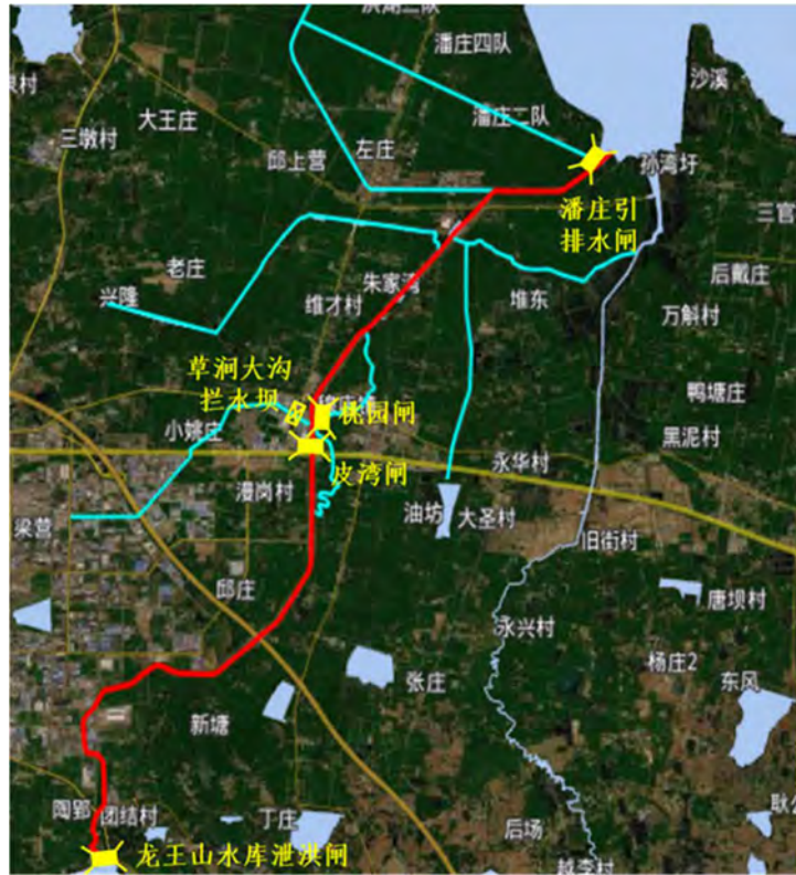
图 6.7.1-2 维桥河干流和支流闸坝分布情况
