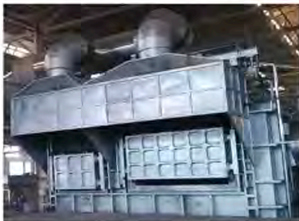
图 3.3.1 拟建项目拟采取的集气罩照片
