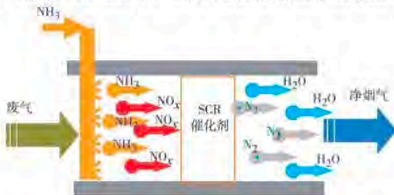
图 6.3.1-3 选择性催化还原脱硝法 (SCR) 基本原理示意图
